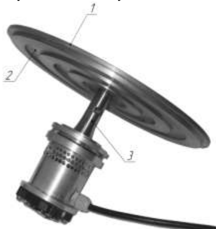
1 - диск; 2 - фазовыравнивающие канавки; 3 - колебательная система
