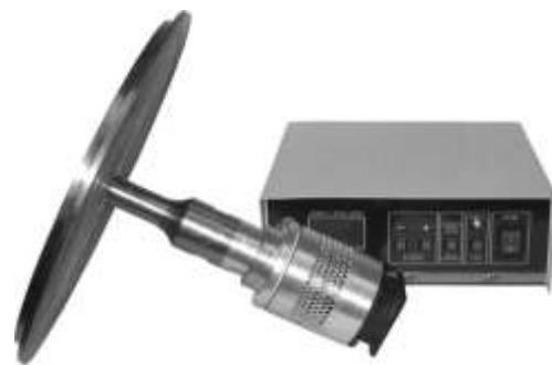
Рис. 11. Ультразвуковой аппарат для фокусированного высокоамплитудного осаждения аэрозолей
