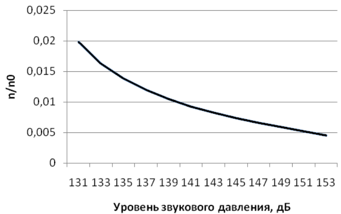
Рис. 3 – Зависимость изменения концентрации за 15 секунд от уровня звукового давления для частиц размером 3 мкм и концентрацией 3 \cdot 10^{11} \text{ м}^{-3} на частоте 20 кГц
